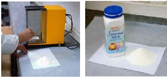
شکل ۱- پودر شیرتجاری و چگونگی توزین آن به وسیله ترازوی دیجیتال
